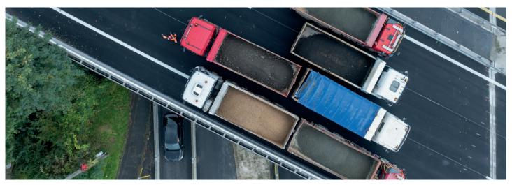
L'opération consiste à positionner des camions chargés, répartis sur chaque ouvrage afin d'en mesurer sa déformation. Ces analyses réglementaires seront ensuite adressées aux services de l'État dans le cadre du contrat de concession. Les essais de charge auront lieu en deux phases, de nuit, sous fermeture de l'autoroute A10 entre les échangeurs de Tours-nord (n°19) et de Joué-lès-Tours (n°24).
